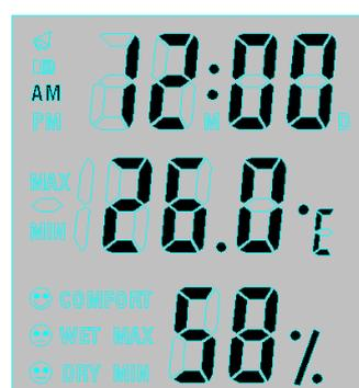
按住[MEMORY]鍵 2 秒鐘，可清除最高/最低溫度和相對濕度，此時的最高/最低溫度和相對濕度即是當前溫度和相對濕度。
